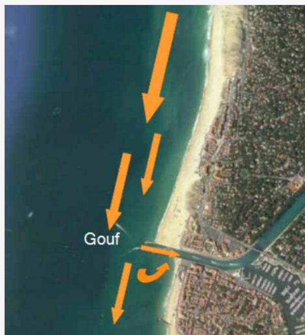
Le sable en suspension qui entre dans le Boucarot, porté par le flot, provient donc essentiellement de ce **courant de dérive littorale**, lequel est dévié et accentué par la présence d'une dune sous-marine située à l'entrée de la passe, dune qui constitue une barre dangereuse à franchir dans certaines conditions de mer.
